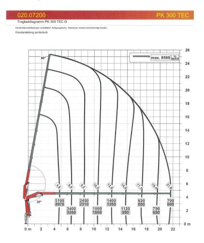
Maximale Hubkraft 700 Kg bei 22 M Reichweite Maximaler Platzbedarf für Abstützung 5.5 M Maximaler Stützenbodendruck
