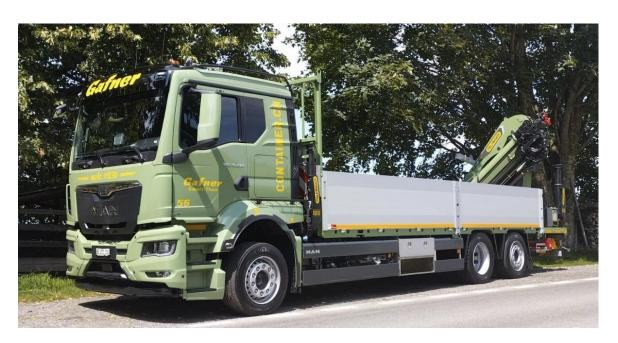
Abmessungen Ladefläche Länge: 6.6M Breite: 2.50M Ladekante Höhe: 1.05 M
