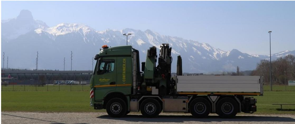
Abmessungen Ladefläche Länge: 4.00m Breite: 2.50m Ladekante Höhe: 1.35m
