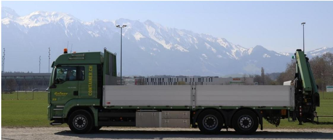
Abmessungen Ladefläche Länge: 7.00m Breite: 2.50m Ladekante Höhe: 1.20m
