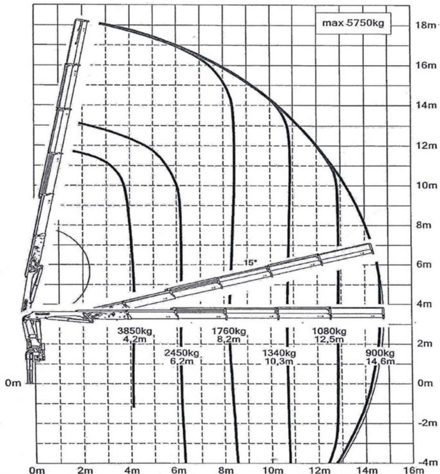
Maximale Hubkraft 900 Kg bei 15 M Reichweite
